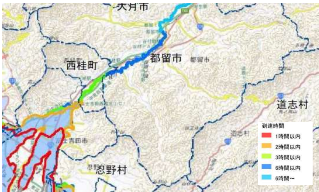
図 融雪型火山泥流の到達想定時間マップ ～富士山ハザードマップ（改定版）検討委員会報告書より～
